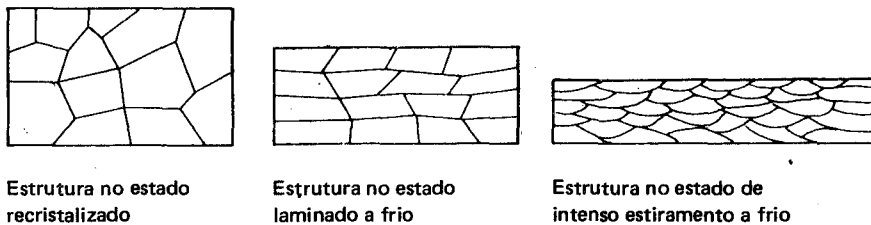
Figura 34 Representação esquemática do efeito do encruamento na estrutura metálica.
