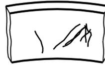
**Sulcamento** é provocado pela batida de uma ferramenta qualquer sobre a pista rolante.
