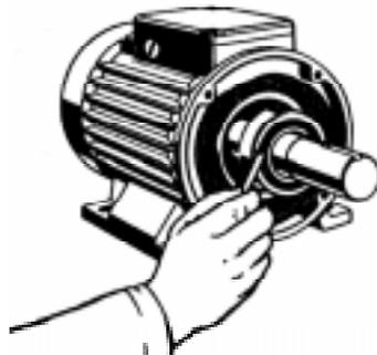
Assegure-se de que não haverá penetração de sujeira e umidade, depois da retirada dos vedadores e das tampas. Proteja o conjunto com papel parafinado, plástico ou algum material similar. Evite o uso de estopa.
